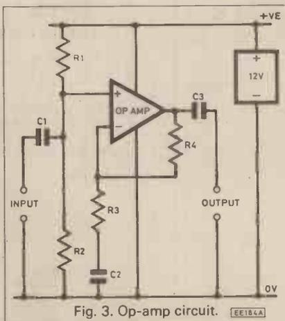
Fig. 3. Op-amp circuit.
