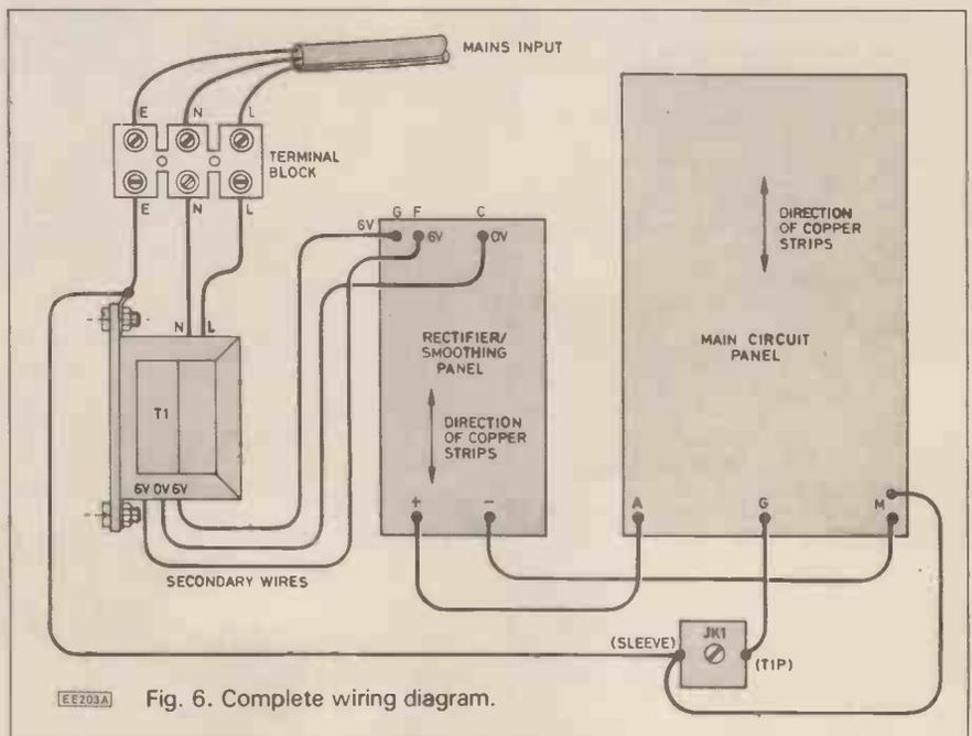
Fig. 6. Complete wiring diagram.
