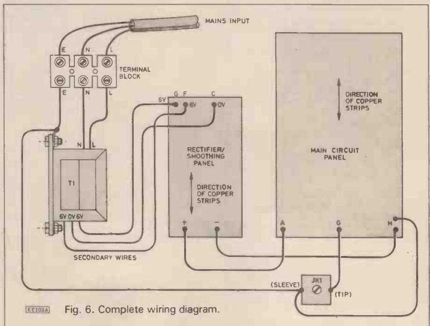
Fig. 6. Complete wiring diagram.
