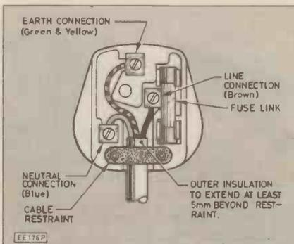
Fig. 14. Correct method of wiring a 13A plug.
