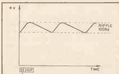
Fig. 1. 100Hz ripple.
