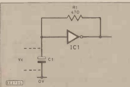
Fig. 3. A simple oscillator.
