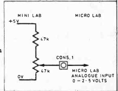
Fig. 11.11. 0-2.5 volt source - data logging simulator.
