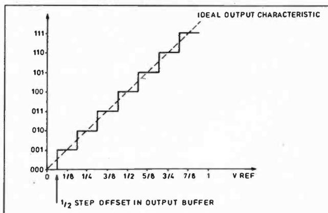
Fig. 11.5. 3-Bit DAC output.
