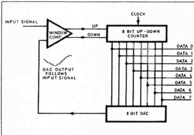
Fig. 11.7. Tracking ADC.
