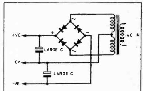
Fig. 6. Simple capacitor/rectifier p.s.u.
