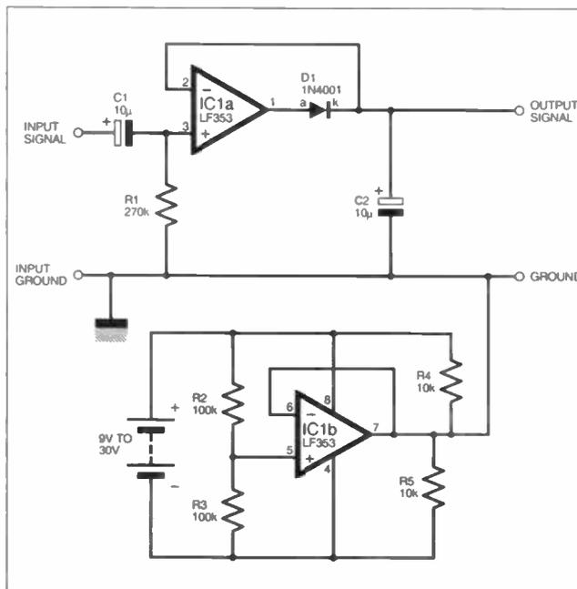
Fig.2. A.C. ripple active rectifier.
