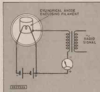
Fig. 2 Diode valve.
