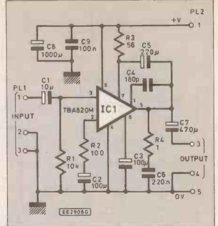
Fig. 3.15 TBA820M power amplifier module
