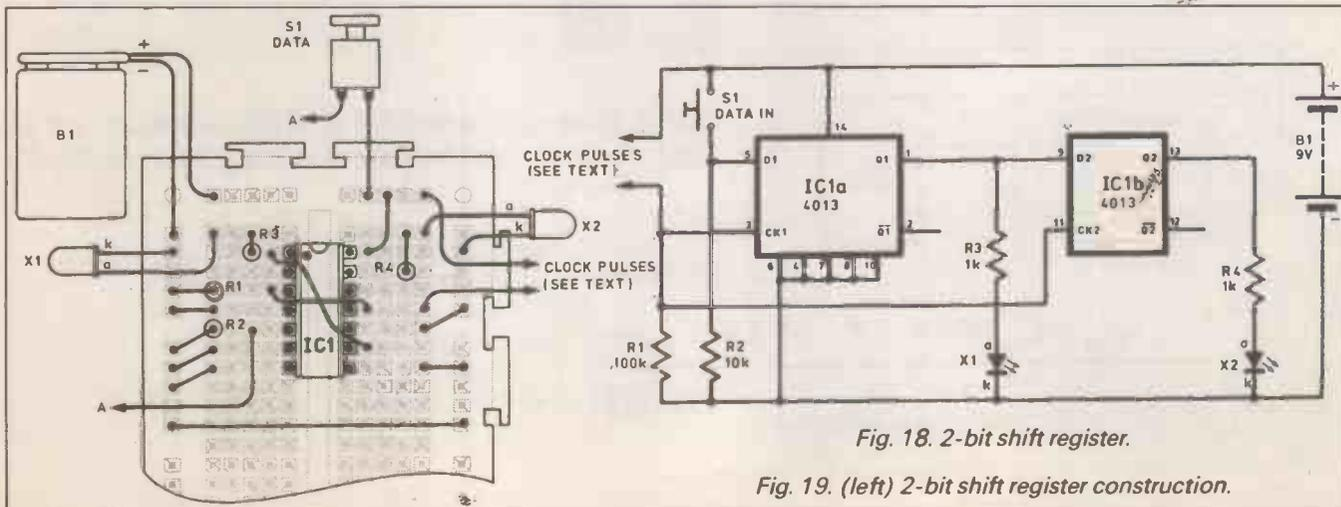
Fig. 18. 2-bit shift register.
