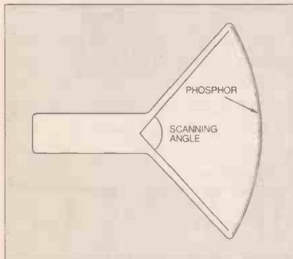
Fig. 22. Scanning angle.
