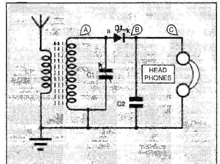
Fig. 8. A simple crystal radio.
