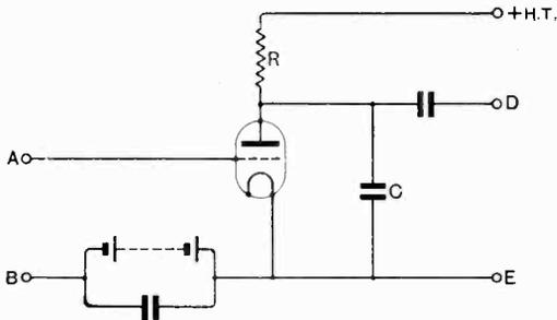
Fig. 1.—Anode bend rectifier.
