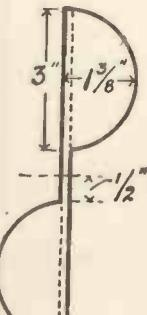
Fig. 7.—The Propeller.
