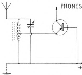
Fig. 5—Emitter detector
