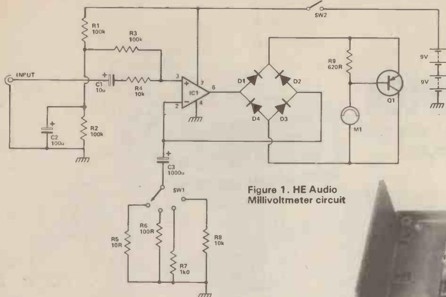
Figure 1. HE Audio Millivoltmeter circuit
