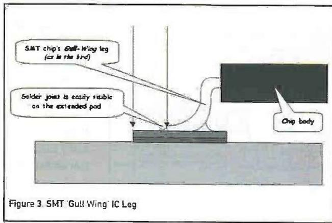
Figure 3. SMT 'Gull Wing' IC Leg
