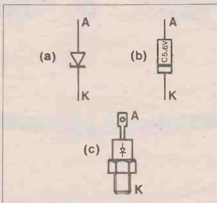
Figure 3. a) Zener diode symbol, b) Plastic case, c) Metal stud.
