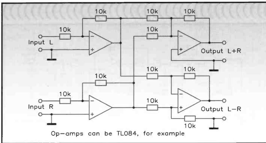
Figure 27. M-S or  $\Sigma$ - $\Delta$  matrix.
