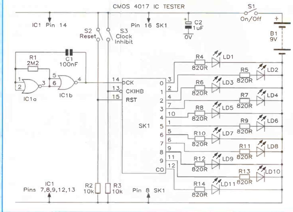
Figure 2. CMOS 4017 IC tester.
