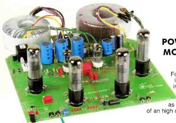
**MONO VALVE POWER AMPLIFIER MODULE 90WRMS**
