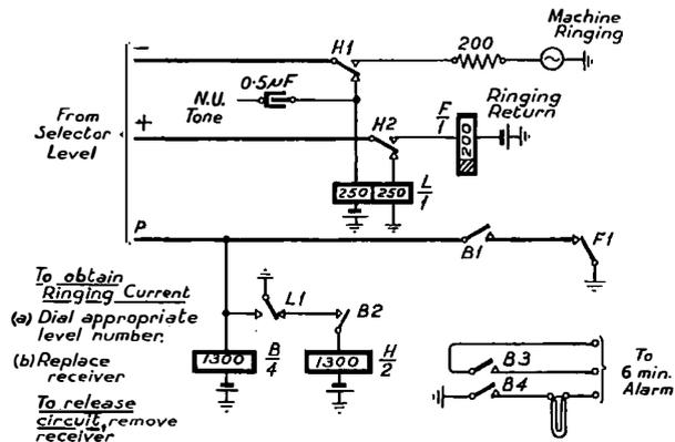
FIG. 3.—FAULTSMEN'S RINGING-BACK CIRCUIT.
