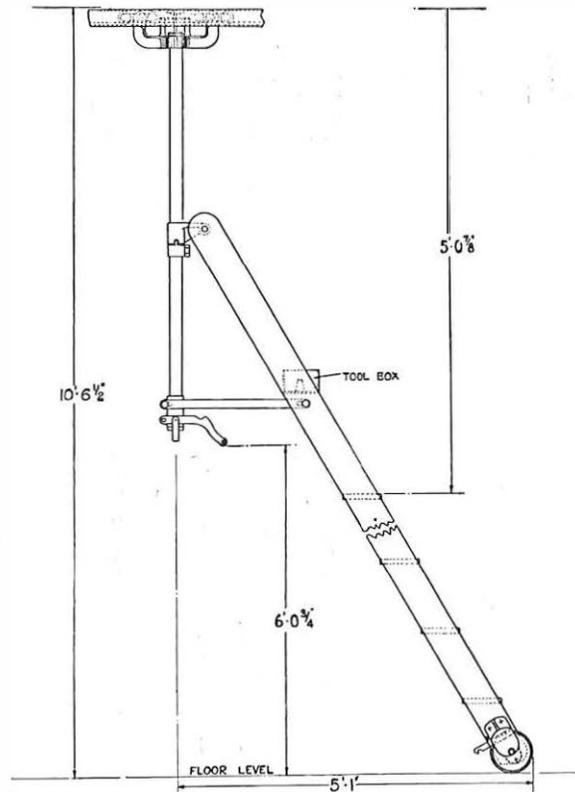
FIG. 1.—SIDE VIEW OF LADDER READY FOR USE.
