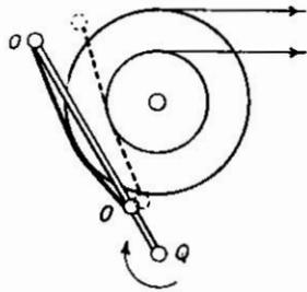
FIG. 3.—CONSTANT TENSION BOBBIN BRAKE.
