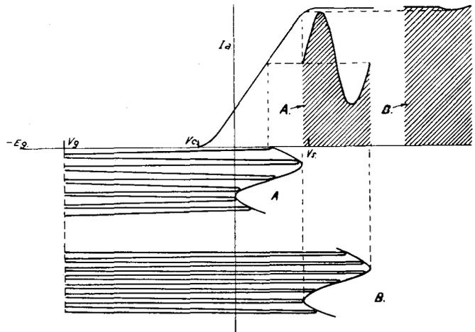
FIG. 4.—DOUBLER OPERATION; EXCITATION MODULATED AT LOW FREQUENCY.
