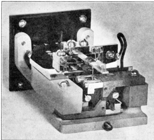
FIG. 2.—VOICE FREQUENCY RELAY.
