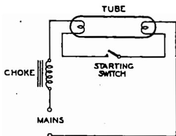
FIG. 3.—ELEMENTARY LAMP OPERATING CIRCUIT.
