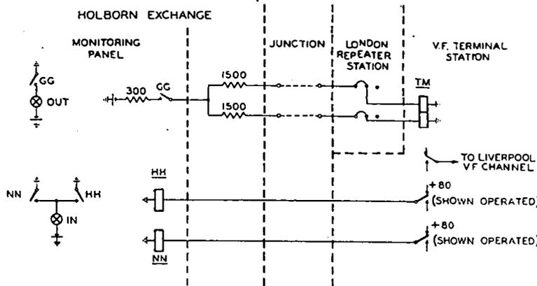
FIG. 4.—MONITORING CIRCUIT
