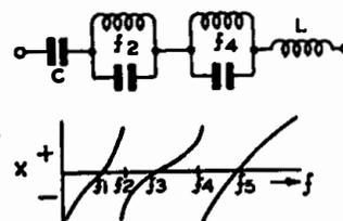
FIG. 4.—EXAMPLE FOR FOSTER'S THEOREM.
