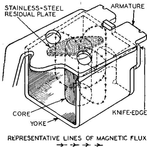
FIG. 3.—MAGNETIC CIRCUIT.
