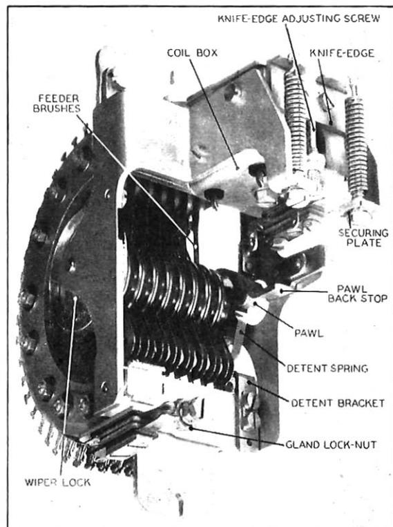
FIG. 2.—P.O. UNISELECTOR TYPE 2—8 LEVEL.
