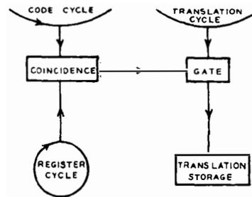
FIG. 8.—THE ELEMENTS OF A PULSE REGISTER-PULSE TRANSLATOR.
