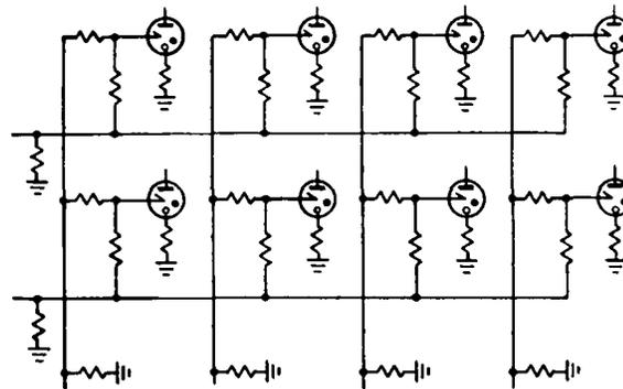
FIG. 2.—A CODED IMPULSE REGISTER.
