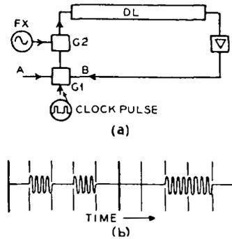
FIG. 4.—SUPERSONIC DELAY LINE REGISTER—(a) SCHEMATIC OF CIRCULATION SYSTEM. (b) PORTION OF CYCLE AS INDICATED BY A CATHODE-RAY TRACE.
