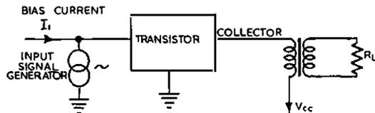
FIG. 24.—BASIC AMPLIFIER CIRCUIT.
