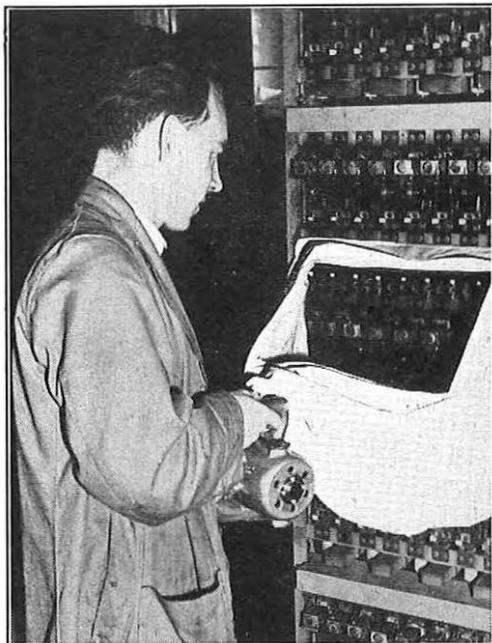
FIG. 3.—THE FRONT SHROUDING BAG WITH PLASTIC WINDOW.
