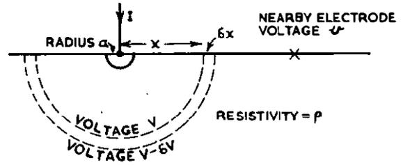
FIG. 6.—EARTH-RESISTANCE COUPLING.
