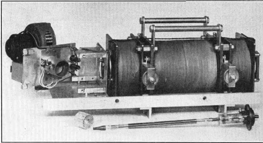
FIG. 14.—TRAVELLING-WAVE AMPLIFIER.
