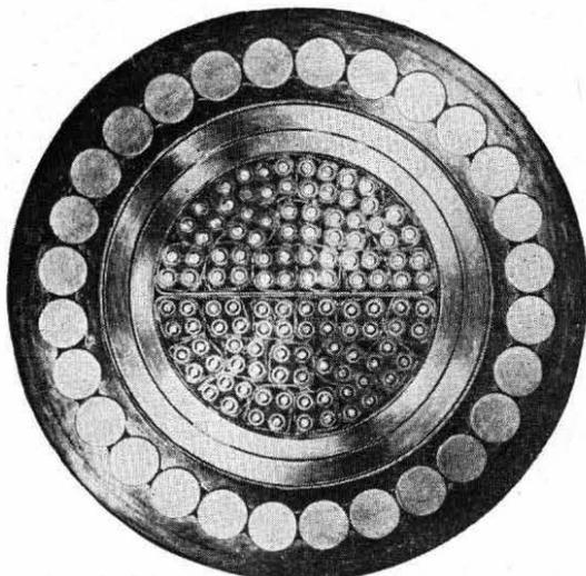
FIG. 6.—CROSS-SECTION OF ANGLO-BELGIAN CABLE OF 1932 (ACTUAL SIZE).
