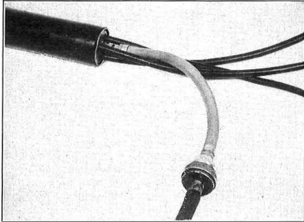
FIG. 6.—PRESSURE-TESTING A JOINT HAVING A PLASTIC SLEEVE.
