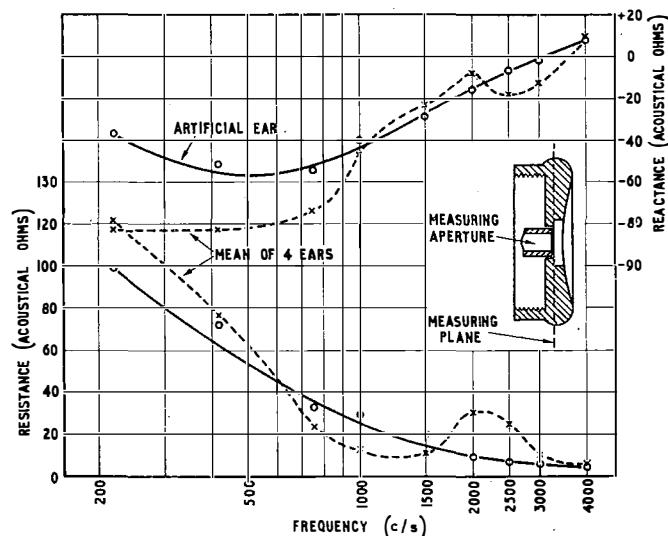
FIG. 2.—ACOUSTICAL IMPEDANCE OF REAL AND ARTIFICIAL EARS.
