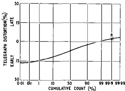
FIG. 1—DISTORTION MEASURED ON A TYPICAL CIRCUIT
