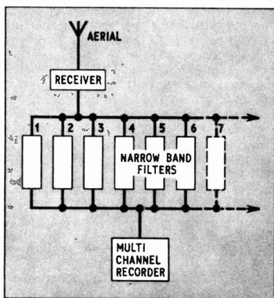
Fig. 3.10. A multi-channel spectrometer
