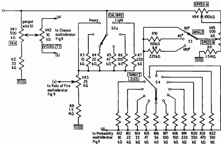
Fig. 8. Analogue parameter controls (stage one)
