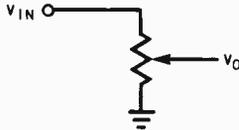
Fig. 1.4. Coefficient Multiplier
