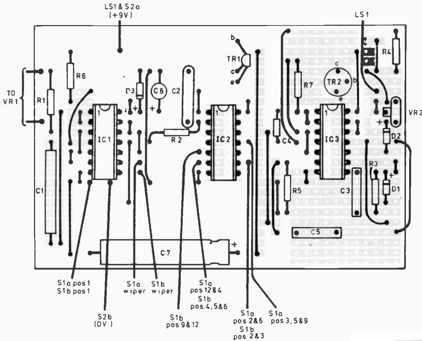
Fig. 2. Stripboard layout shown actual size
