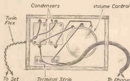
Fig. 2.—Wiring plan.
