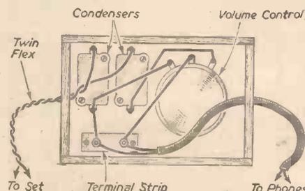
Fig. 2.—Wiring plan.
