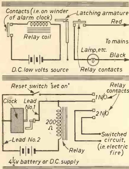
Fig. 46 (Top).—Time switch relay system.
