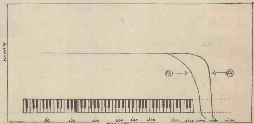
(A) ACOUSTIC FREQUENCIES REPRODUCED BY THE "STENODE" RECEIVER
