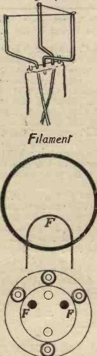
Fig. 2.—The filament.
