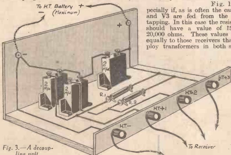
Fig. 3.—A decoupling unit.
