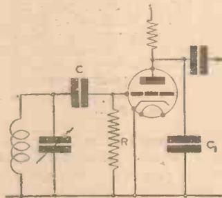
Fig. 26.—The standard grid rectifier circuit.
