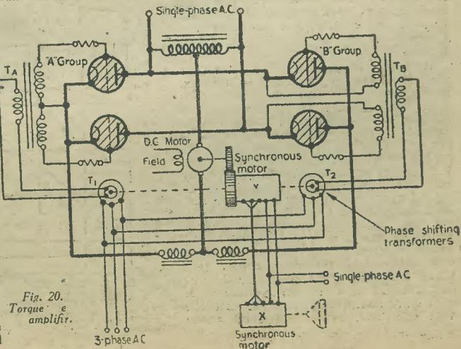
Fig. 20. Torque amplifier.
