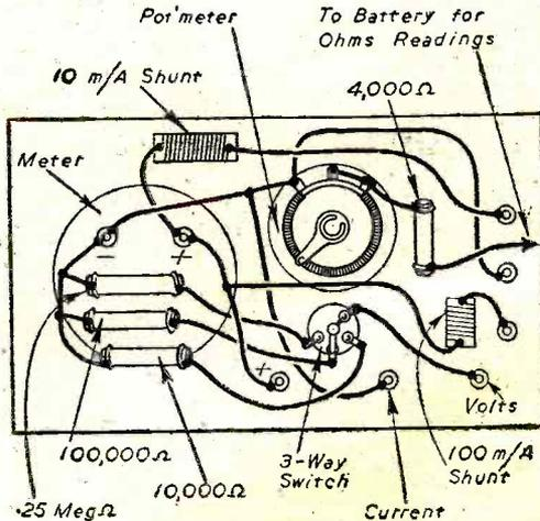
Fig. 2.—Wiring Plan.
