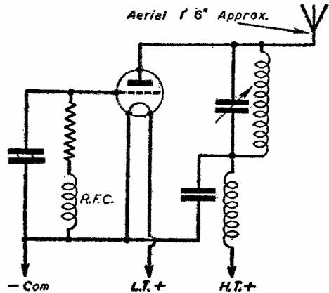
Fig. 3.—100 kc/s crystal oscillator.
