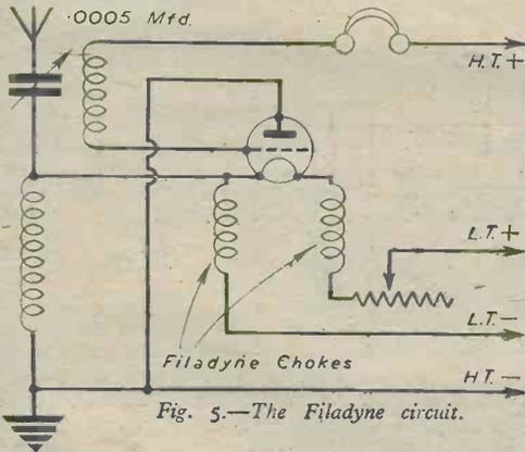
Fig. 5.—The Filadlyne circuit.
