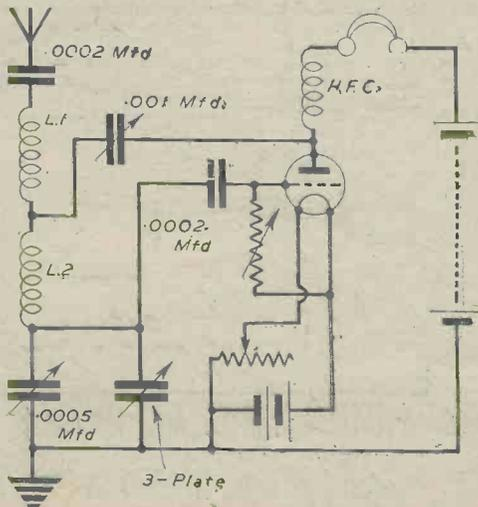
Fig. 3.—The Ultra-Audion circuit.
