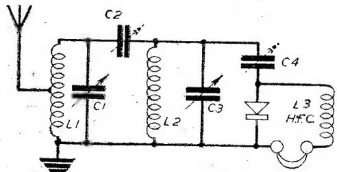
Fig. 28.—Another Crystachoke circuit.
