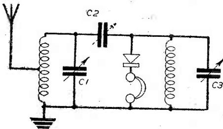
Fig. 27.—The Crystachoke circuit.
