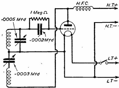
Fig. 1.—Oscillating Triode.
