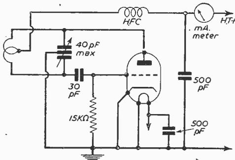
Fig. 55.—A V.H.F. test oscillator.
