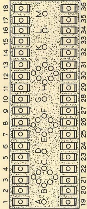
Fig. 9 - LAYOUT OF I.F. AMP. GROUPBOARD
