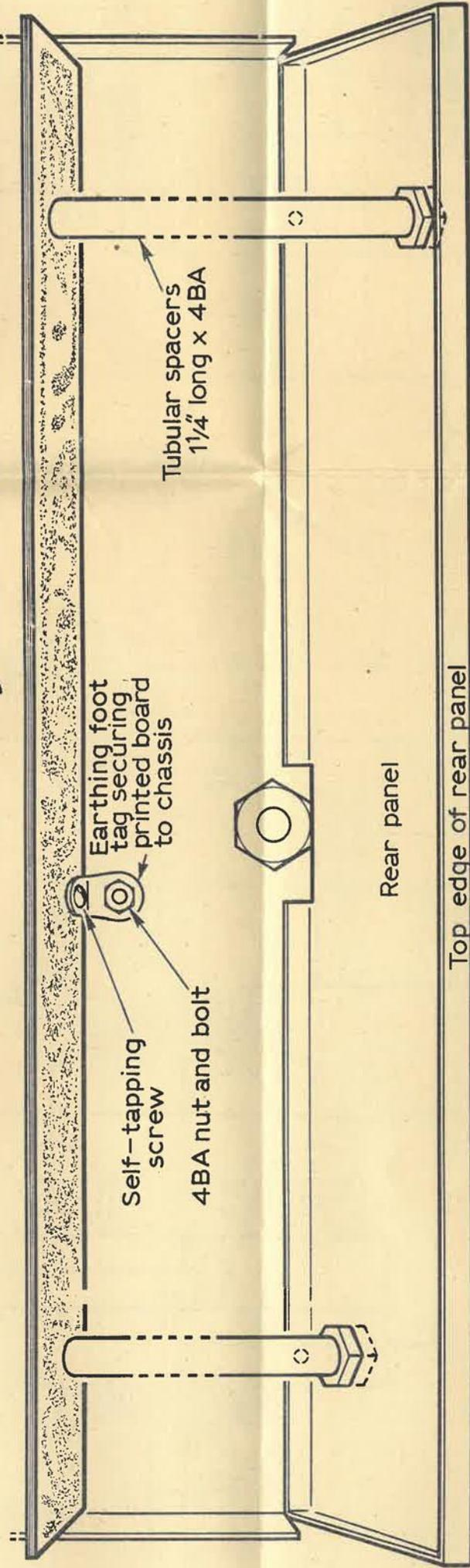
**Fig. 4 SECURING PRINTED CIRCUIT BOARD**
