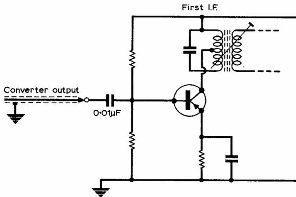
(d) Converter coupled to a 1.6MHz I.F. strip.
