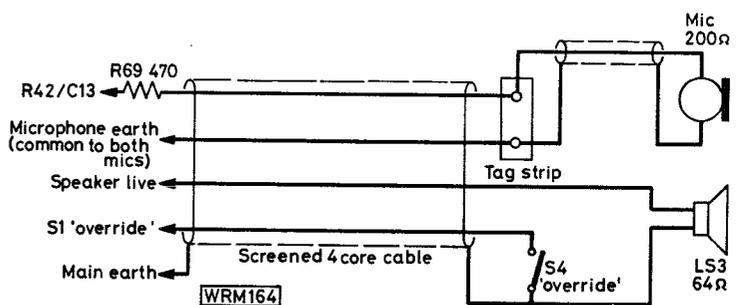
Fig. 7: Front door unit wiring diagram
