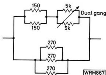
Fig. 2: A variable QRP load
